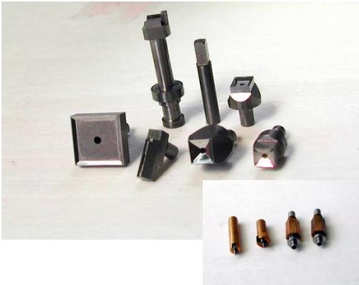
チップの厚みの半分(又はご指定の割合)が、ダイコレットのポケットに納まるよう角錐の内側寸法を設定していますので、ダイはしっかり押えられます。又、オプションとしてチップエッジの欠け防止の為にコーナリリーフも加工しています。コーナリリーフの形状、サイズ等ご注文の際に付記して頂ければ、特に条件が特殊でない限り加工費はサービスしております。4辺のフラット幅は隣接するチップに接触しないよう20 $\mu$ mまで小さく加工できます。
